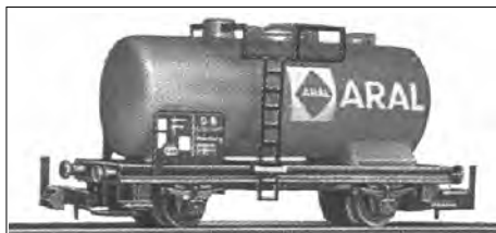
Auch der alte ARAL-Kesselwagen ist von der Zinkpest bedroht
