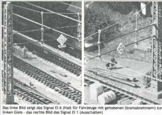
Das linke Bild zeigt das Signal EI 6 (Halt für Fahrzeuge mit gehobenen Stromabnehmern) zum linken Gleis - das rechte Bild das Signal EI 1 (Ausschalten)
