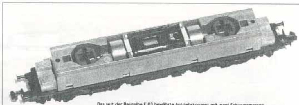
Das seit der Baureihe E 03 bewährte Antriebskonzept mit zwei Schwungmassen
