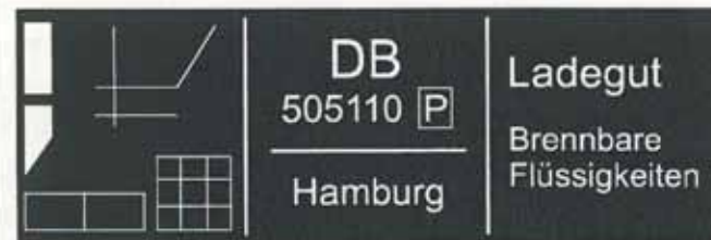
Das erste Gattungsschild der zweiachsigen Kesselwagen bestand aus einem Aufkleber und wurde direkt auf die seitliche Kunststofftafel aufgeklebt.
