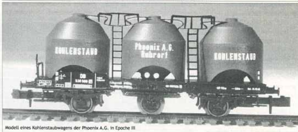
Modell eines Kohlenstaubwagens der DR (DDR) mit geschweißten Behältern in Ausführung der Epoche III
