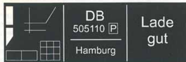
Das erste Gattungsschild der zweiachsigen Kesselwagen bestand aus einem Aufkleber und wurde direkt auf die seitliche Kunststofftafel aufgeklebt.
