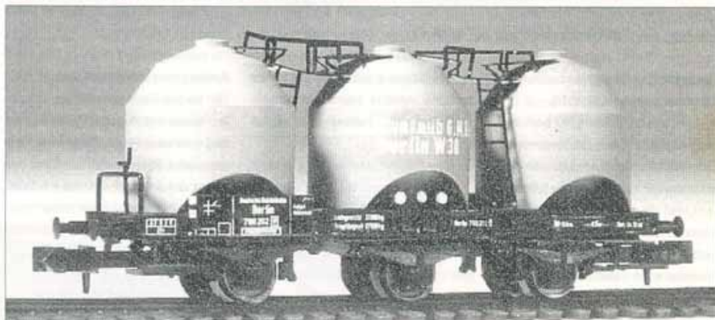
Modell eines Kohlenstaubwagens der DR (DDR) mit geschweißten Behältern in Ausführung der Epoche III
