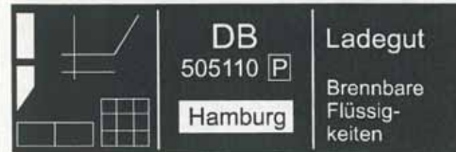
Die weiteren Gattungsschilder wurden direkt mittels Tampondruck aufgedruckt - zu beachten sind die unterschiedlichen Ausführungen der Aufschriften.
