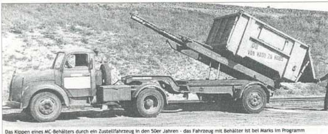
Das Kippen eines MC-Behälters durch ein Zustellfahrzeug in den 50er Jahren - das Fahrzeug mit Behälter ist bei Marks im Programm
