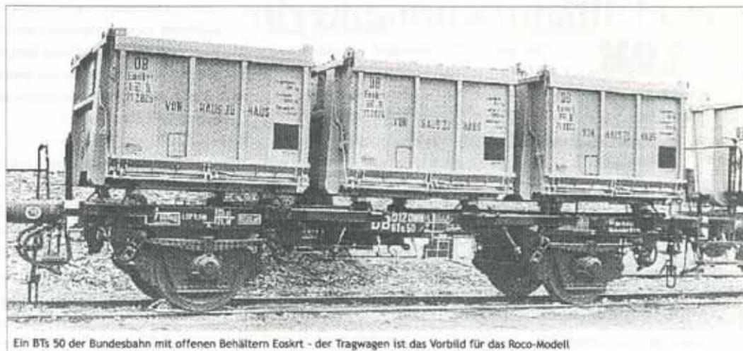
Ein BTs 50 der Bundesbahn mit offenen Behältern Eoskrt - der Tragwagen ist das Vorbild für das Roco-Modell
