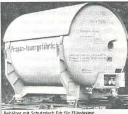
Behälter mit Schutzdach Edr für Flüssiggase
