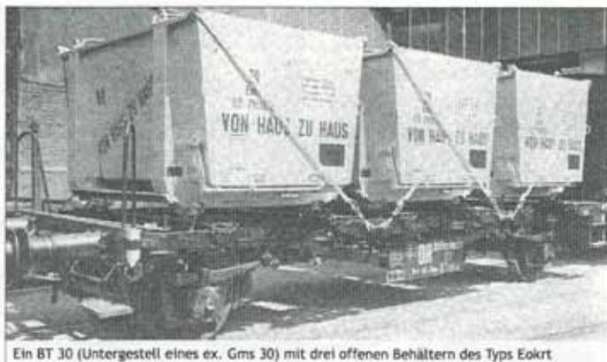
Ein BT 30 (Untergestell eines ex. Gms 30) mit drei offenen Behältern des Typs Eokrt
